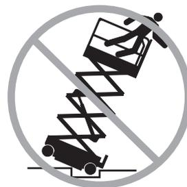
Ne pas conduire la machine avec la nacelle relevée sur un terrain accidenté, un revêtement instable ou autres situations à risque.
