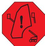
10. Témoin de système de commande de la flèche étalonné
