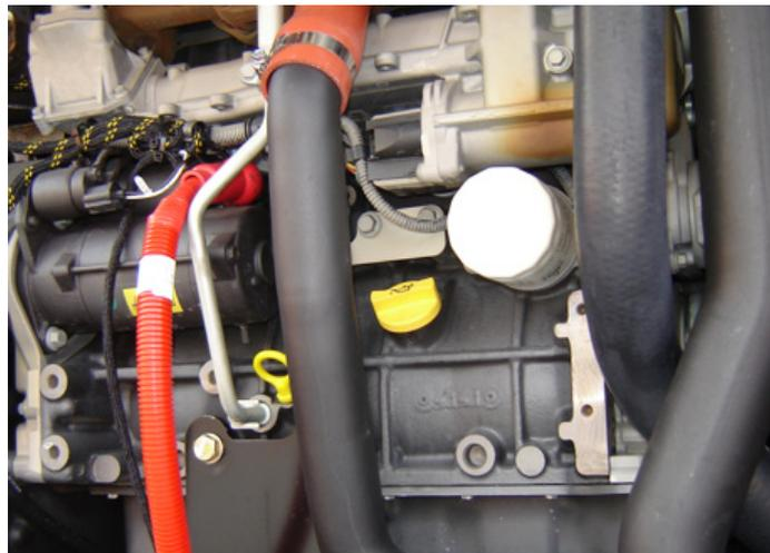
Point(s) de lubrification - Bouchon de remplissage/élément vissable
