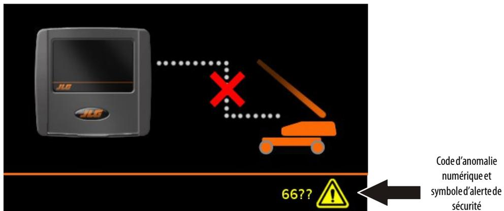
Figure 5-7. Écran d'erreur de communication CAN
