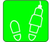
Lorsque l'interrupteur à pédale est relâché, l'alimentation est coupée vers toutes les commandes et les freins d'entraînement sont serrés.
