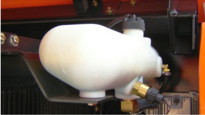
Point(s) de lubrification - Bouchon de remplissage
