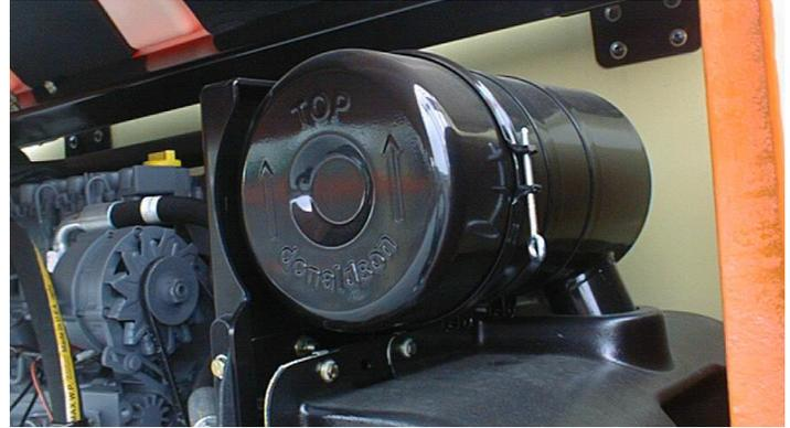
Point(s) de lubrification - Élément remplaçable
