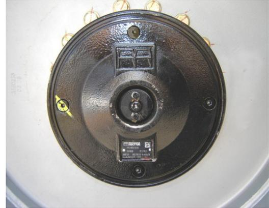
Point(s) de lubrification - Bouchon de niveau/remplissage
