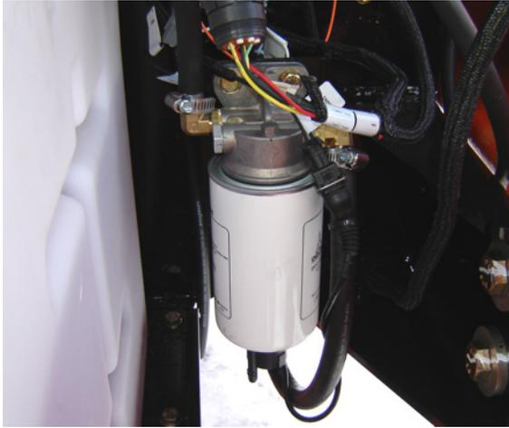
Point(s) de lubrification – Élément remplaçable
