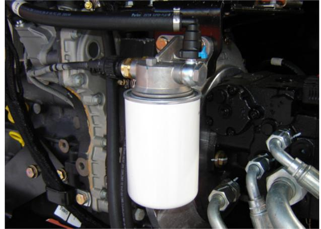
Point(s) de lubrification – Élément remplaçable
