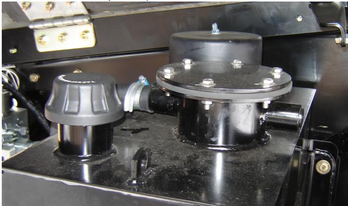
Point(s) de lubrification – Bouchon de remplissage
