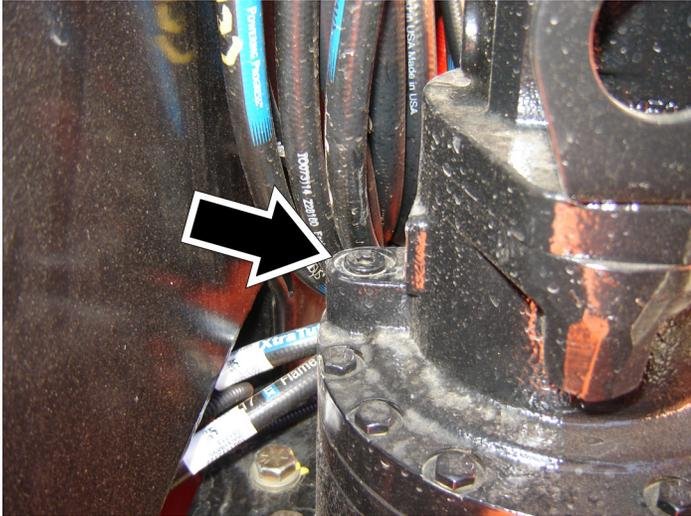
Point de lubrification – Bouchon de niveau/remplissage
