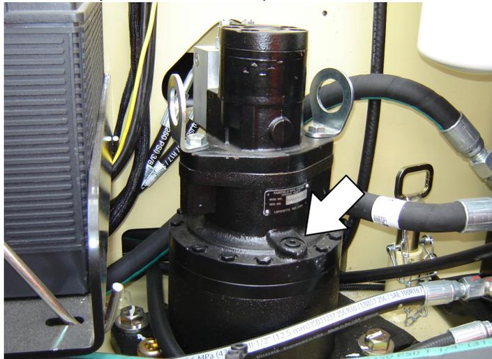
Point(s) de lubrification - Bouchon de niveau/remplissage
