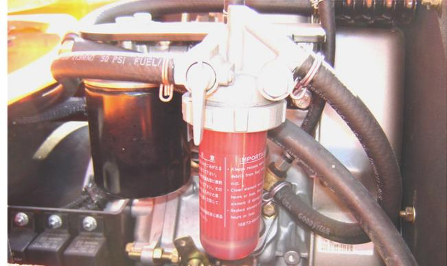
Point(s) de lubrification - Bouchon de remplissage
