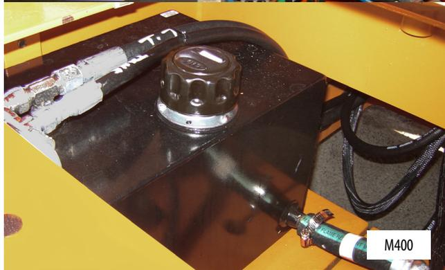
Point(s) de lubrification - Bouchon de remplissage
